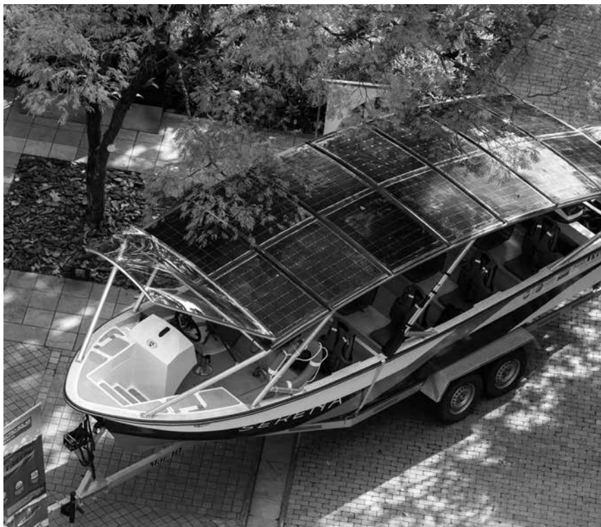
La lancha electrosolar tuvo sus primeras pruebas sobre agua en la represa La Fe. Cuenta con 14 metros cuadrados de área solar capaces de moverla hasta 41 km por hora.
